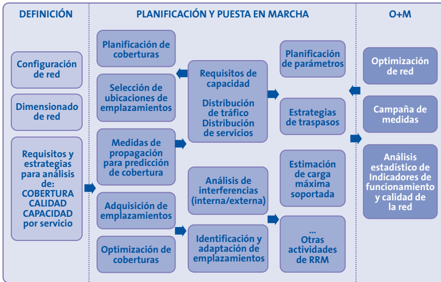
Figura 7-1: Proceso de planificación de la red de acceso radio
